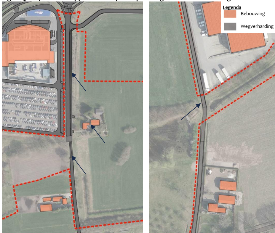
Figuur 3 en 4: Verhard oppervlak nabij Scherpenering en Paleisstraat huidige situatie
