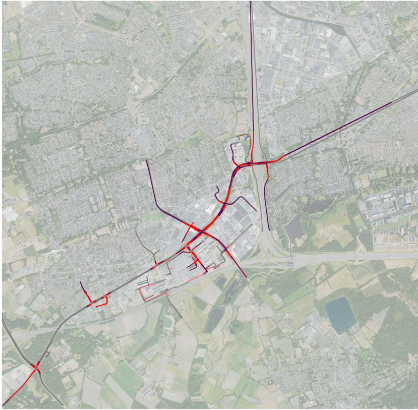
Figuur 4.11: Gemiddeld (rood) en maximale (paars) wachtrijen in de avondspits van de referentievariant (2040)
