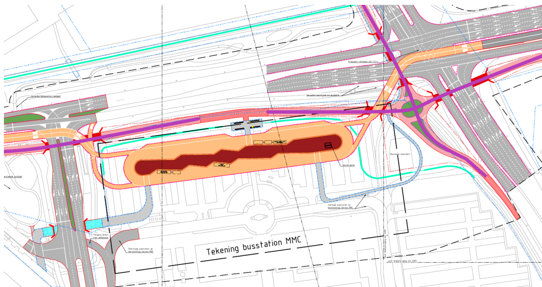
Figuur 4.4 Nieuw busstation MMC (fietstunnels in paars)
