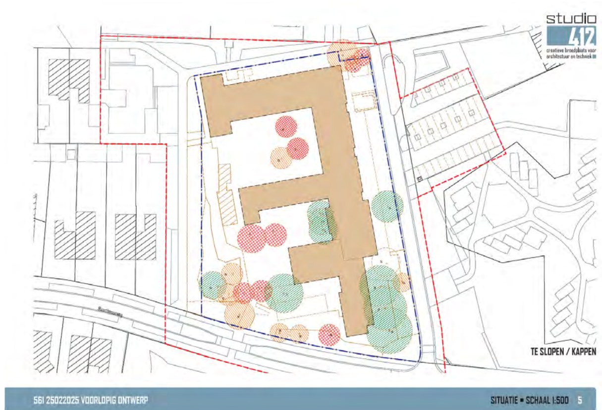
Figuur 1: Gebouwcontour & contour bouwkuip Blaarthemseweg, Veldhoven
