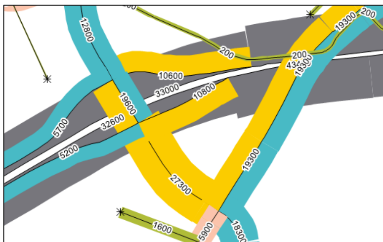
Figuur 4 – Verkeersintensiteiten BBMA 2018 (mvt/etmaal 2030)
