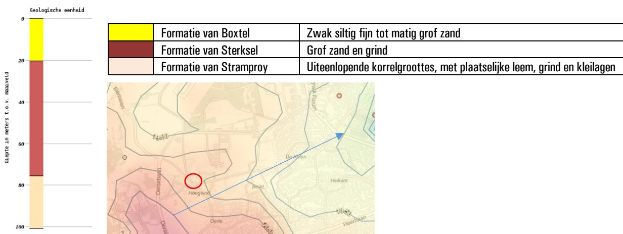
Figuur A: opbouw ondergrond.
