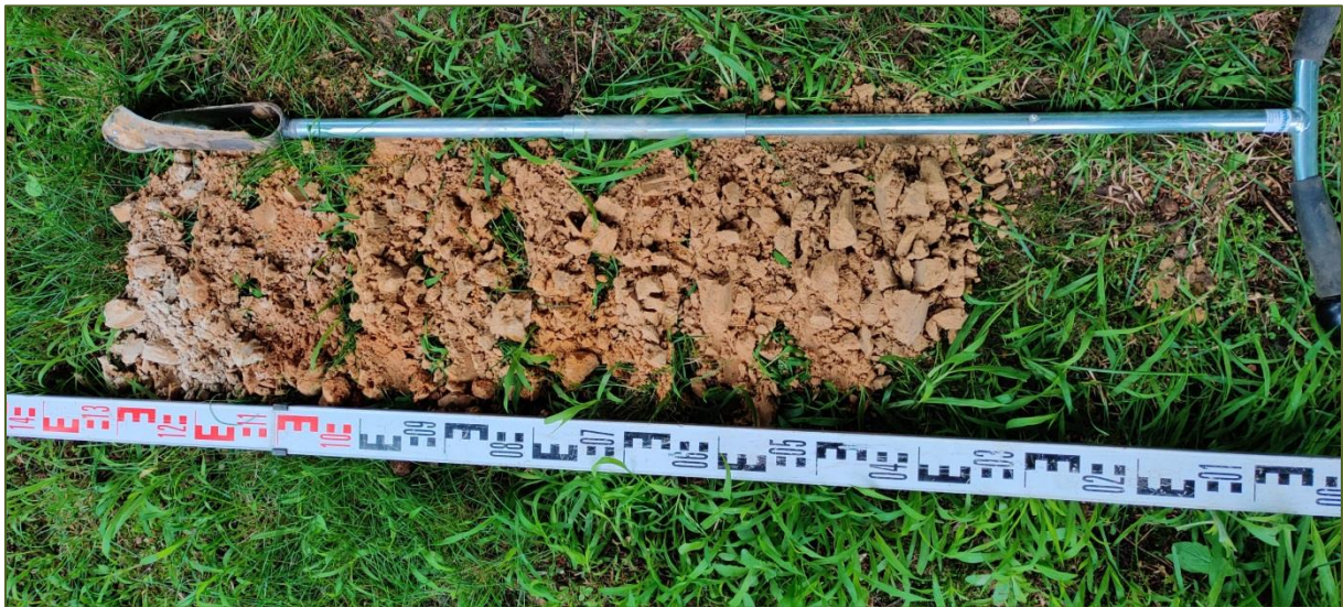
Afbeelding 4: Locatie en inhoud van sleuf vanaf de boom, diepte van de aanwezige stabiliteitswortels en de grondopbouw onder de sleuf.
