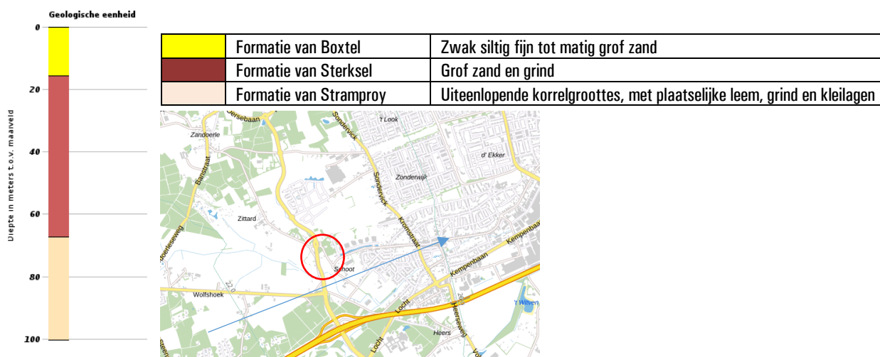
Figuur A: opbouw ondergrond.
