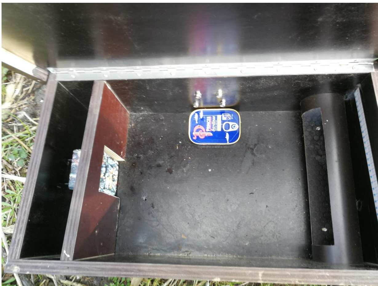
Figuur 3 Binnenzijde van marterbox "Koppelbox01", met daarin de open buis, de camera en de lokstof.
