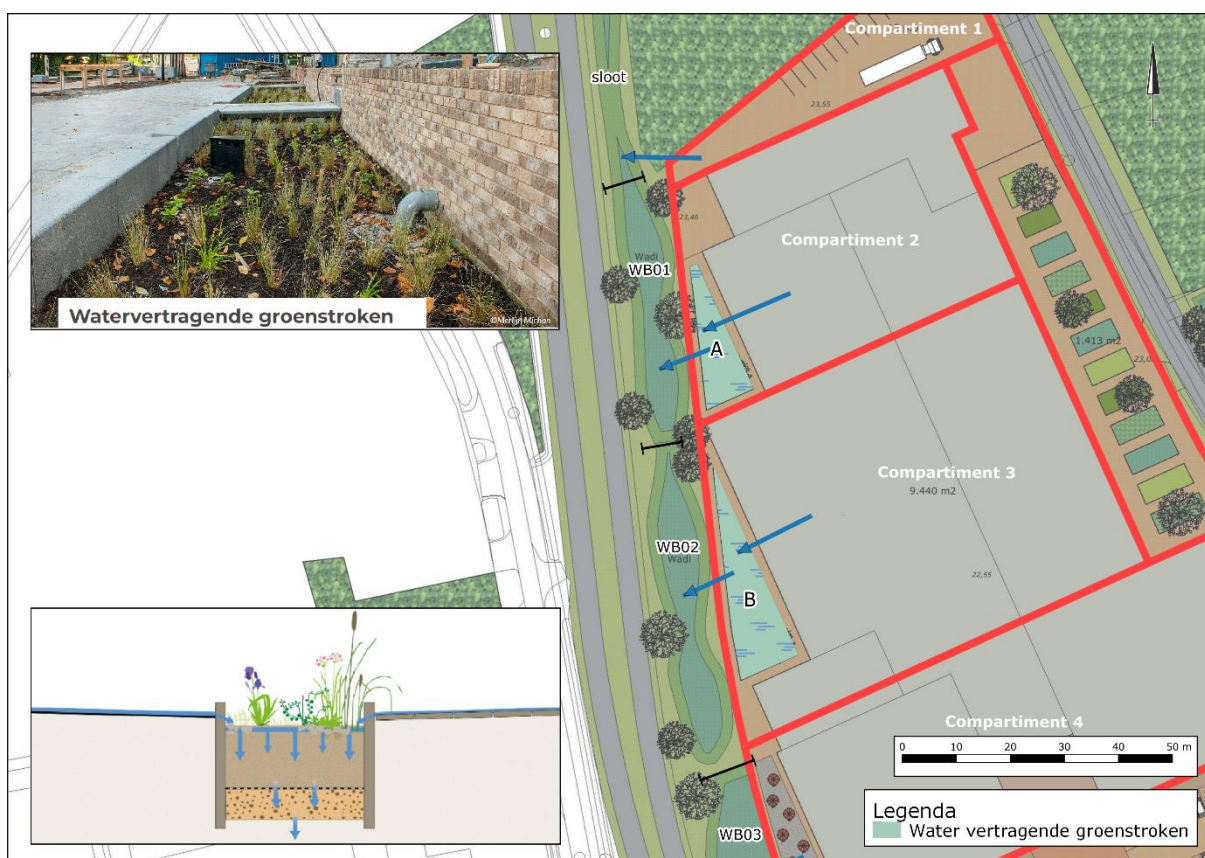
Figuur 6-4: Situering en voorbeeld water vertragende groenstrook
