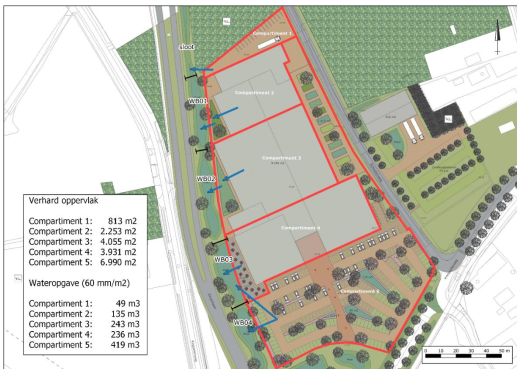
Figuur 6-2: Afwatering hemelwater planlocatie ten westen van de Schooterweg
