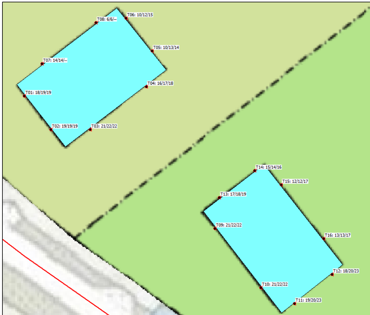
Afbeelding 9. Geluidbelastingen L_{den} (incl. aftrek art. 110g Wgh) Berekende geluidbelastingen op een hoogte van 1,5/4,5/7,5 meter boven het maaiveld
