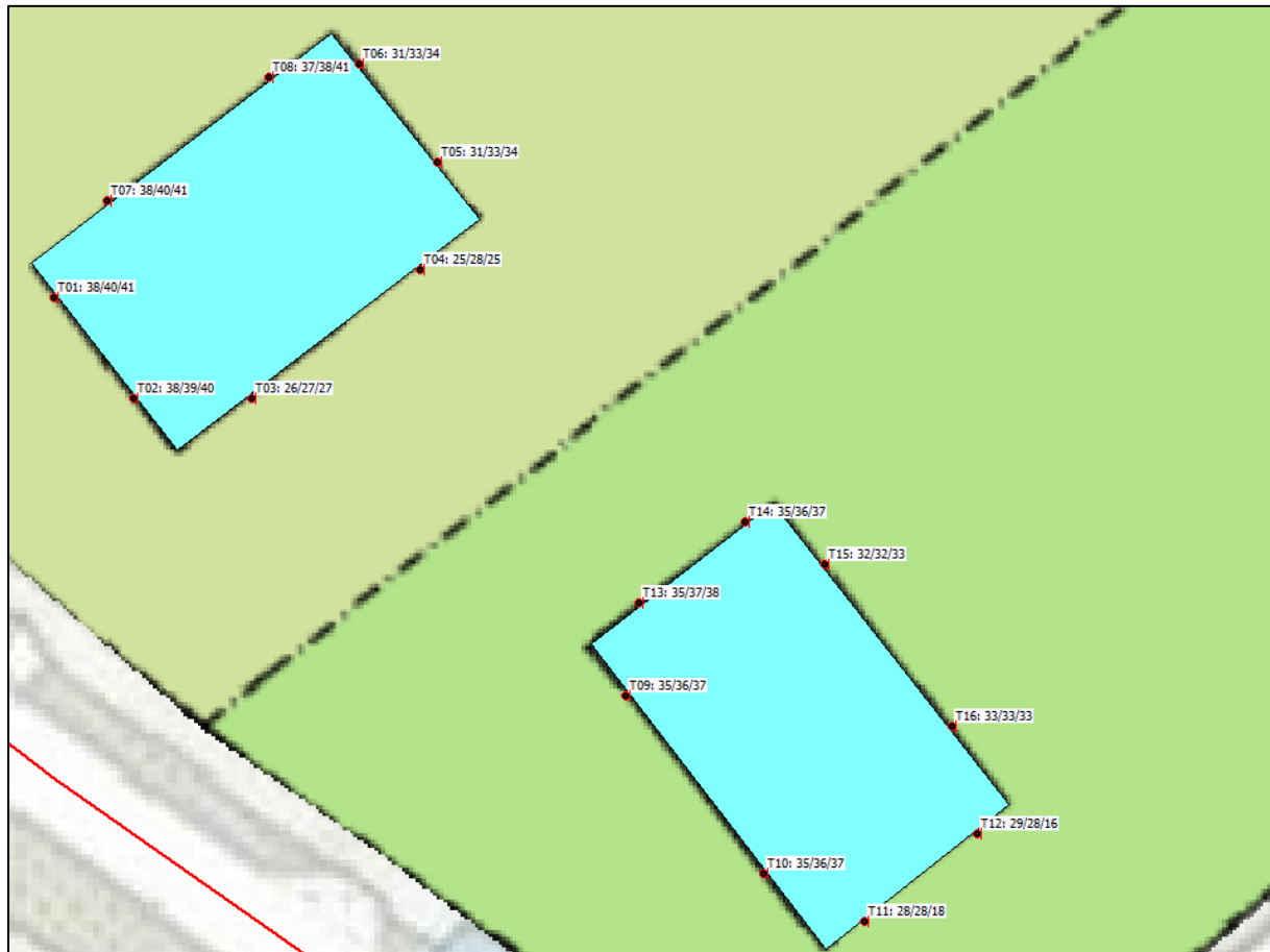
Afbeelding 5. Geluidbelastingen L_{den} (incl. aftrek art. 110g Wgh) Berekende geluidbelastingen op een hoogte van 1,5/4,5/7,5 meter boven het maaiveld
