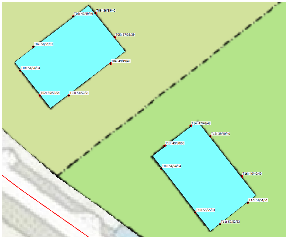
Afbeelding 10. Geluidbelastingen L_{den} (excl. aftrek art. 110g Wgh) cumulatief Berekende geluidbelastingen op een hoogte van 1,5/4,5/7,5 meter boven het maaiveld
