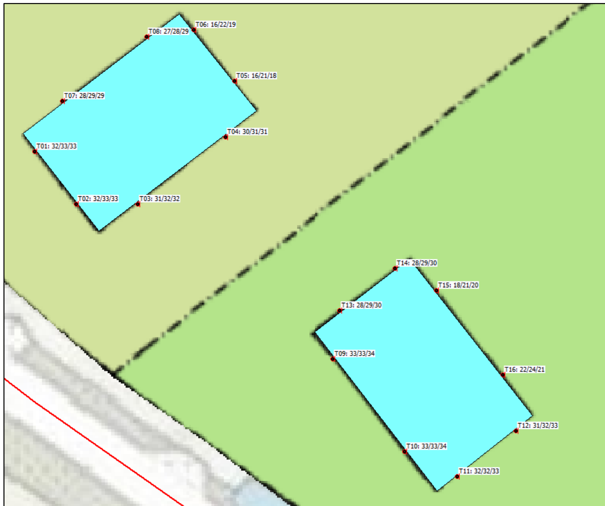
Afbeelding 6. Geluidbelastingen L_{den} (incl. aftrek art. 110g Wgh) Berekende geluidbelastingen op een hoogte van 1,5/4,5/7,5 meter boven het maaiveld
