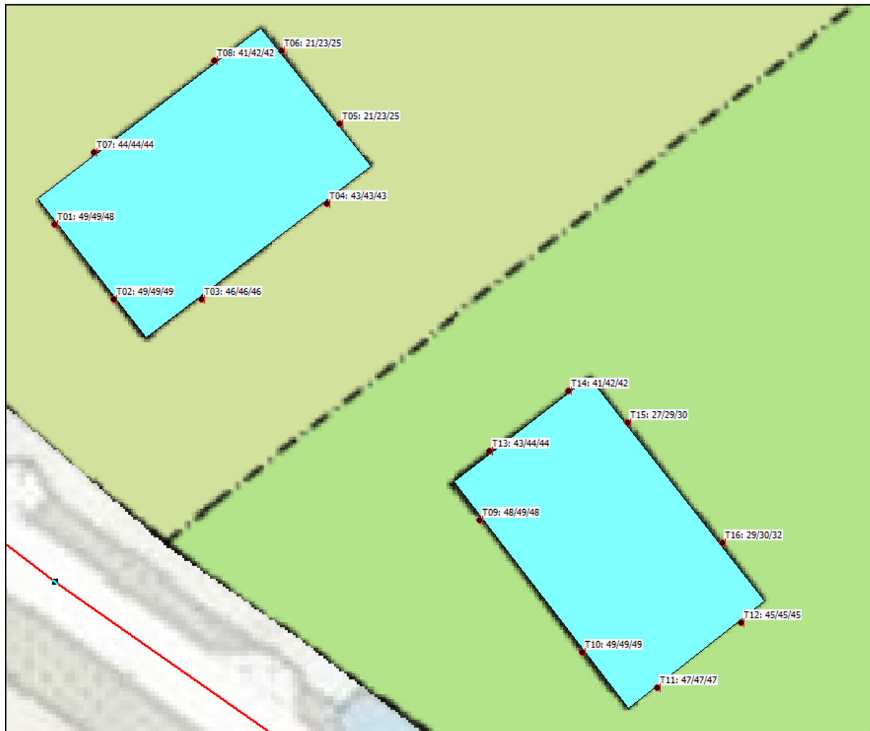
Afbeelding 8. Geluidbelastingen L_{den} (incl. aftrek art. 110g Wgh) Berekende geluidbelastingen op een hoogte van 1,5/4,5/7,5 meter boven het maaiveld
