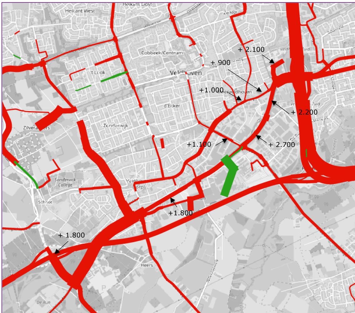
Afbeelding 7. Verschil in etmaalintensiteit op een gemiddelde werkdag tussen de autonome situatie in 2022 en 2032 (afgerond op 100-tallen).
