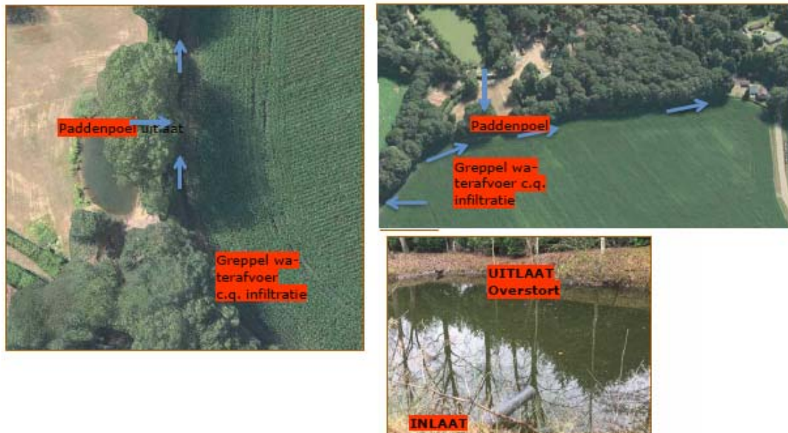
Figuur 3.5 Ligging bergingsloot (greppel) om het park heen en locatie stuw, overstort inlaat en uitlaat
