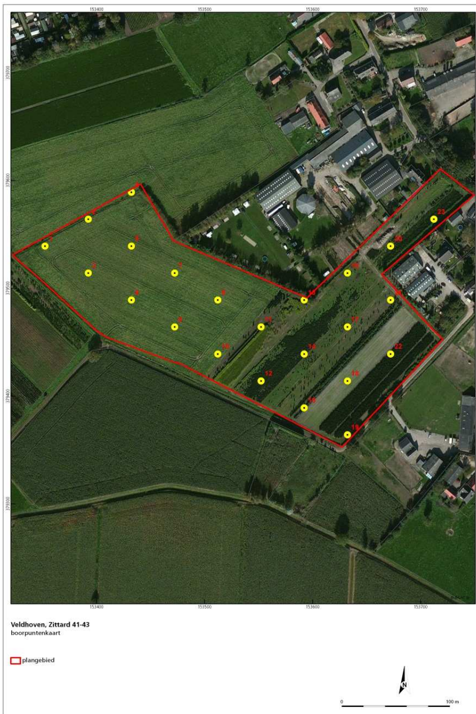
Figuur 3.1 Boorpuntenkaart geprojecteerd op een satellietbeeld (Bing Maps 2012). Voor een grotere kaart wordt verwezen naar bijlage 2.
