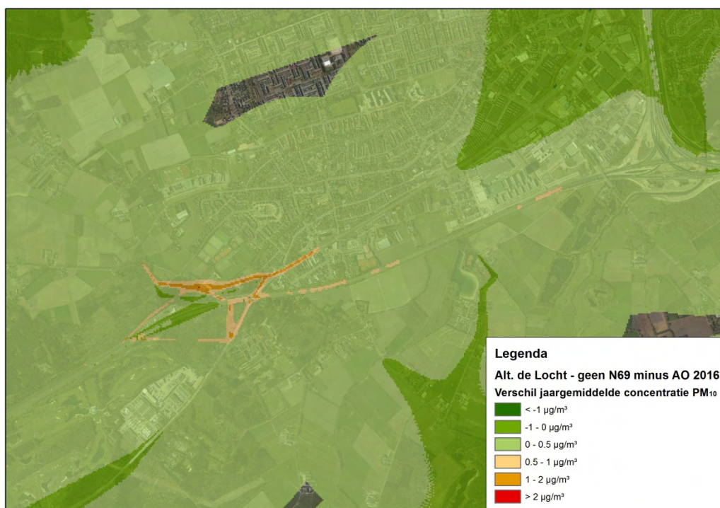
Afbeelding 69: Alternatief 3 zonder Westparallel N69 – Verschil jaargemiddelde concentratie PM 10 t.o.v. autonoom 2016
