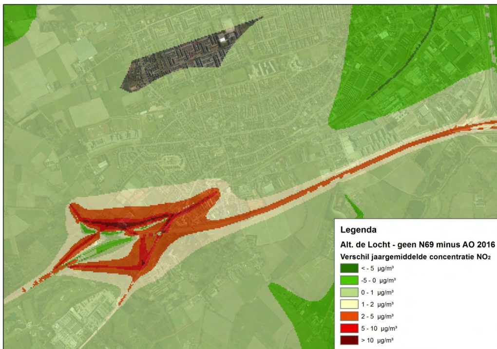
Abbeelding 67: Alternatief 3 zonder Westparallel N69 – Verschil jaargemiddelde concentratie NO 2 t.o.v. autonoom 2016
