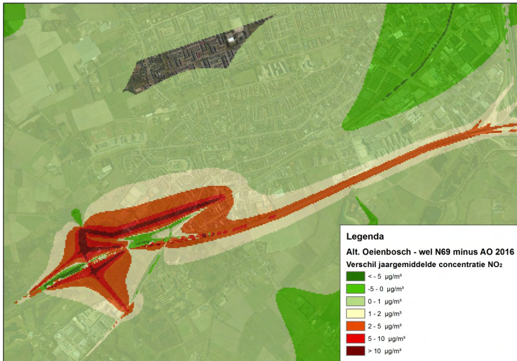
Afbeelding 60: Alternatief 1 met Westparallel N69 – Vershil jaargemiddelde concentratie NO 2 t.o.v. autonoom 2016
